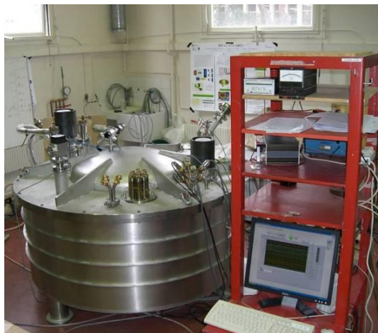
Figure 3-1 : Démonstrateur SMES I en test
