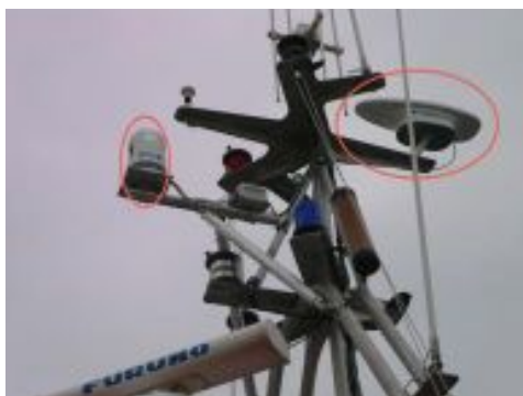
(a) On peut voir la caméra à gauche de l'image ainsi que la centrale inertielle satellitaire à droite de l'image. Le matériel est fixé sur le mat du bateau.
