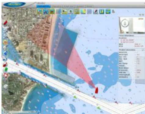
(a) Une vue (2D) de l'interface graphique avec la vidéo thermique en haut à droite ainsi que le cône (rouge) indiquant la direction de la caméra.
