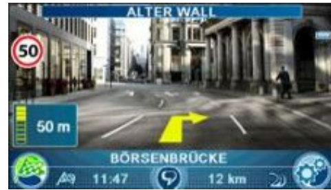
(b) Système d'aide à la conduite automobile de (Blaupunkt, 2010). Combinaison d'une réalité documentée et d'une visibilité augmentée.
