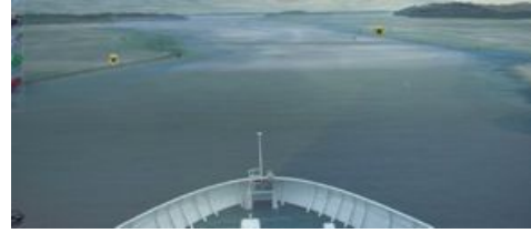
(b) Image extraite d'une séquence d'images avec visualisation de la cartographie. La signification de la scène est rectifiée (Chapitre 2, Section 2.1) afin de proposer les informations de profondeur pour guider le navigateur. Deux informations ponctuelles symbolisant des bouées ont aussi été ajoutées. C'est une combinaison de réalité à compréhension augmentée et de visibilité augmentée.
