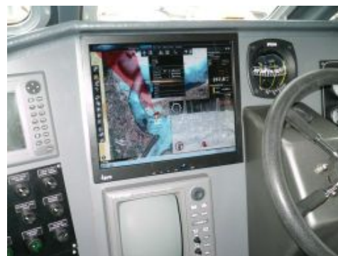
(b) Intégration du logiciel d'aide à la navigation dans la cabine de pilotage du navire.
