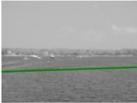
(a) Analyse d'image sans utiliser la centrale inertielle. Une vague est détectée comme étant l'horizon.
