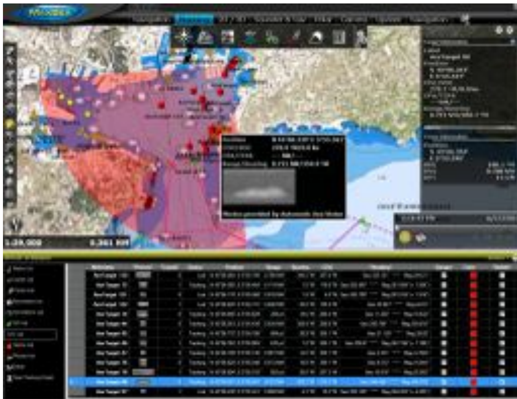
FIGURE 5.27: Les points rouges sur la cartographie sont les navires détectés sur la vidéo dont la position a été estimée à partir des données de distance et de cap. Le tableau regroupe les informations de toutes les cibles. Un cadre permettant de faire apparaître l'image de la cible ainsi que ses informations est accessible en cliquant simplement sur l'objet qui représente un navire. Le quart de cercle rouge illustre toujours le champ de vision de la caméra.
