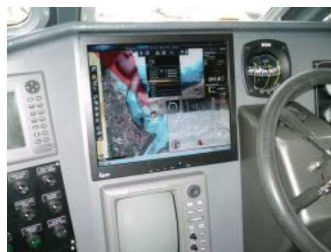
(b) Intégration du logiciel d'aide à la navigation dans la cabine de pilotage du navire.
