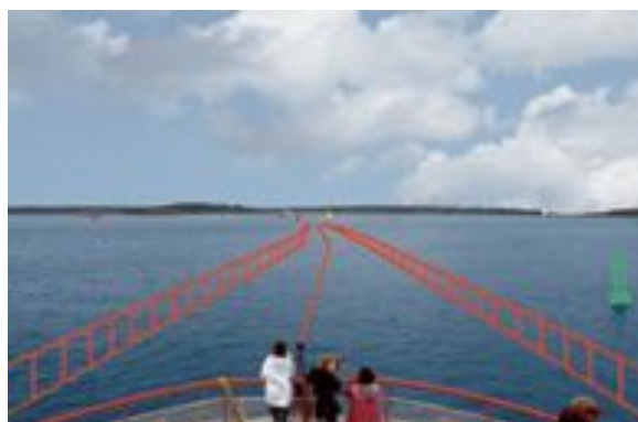
FIGURE 3.21: Réalité augmentée pour l'aide à la navigation maritime. Réalité à compréhension augmentée combinée à de la visibilité augmentée.
