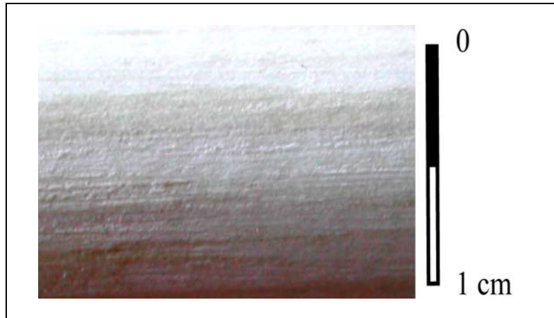
Figure 61 : Raclage sur bois frais de forte densité (Frêne, Fraxinus excelsior ) finement exécuté présentant une absence d'aspérités et des surfaces régulières (résultats expérimentaux Exp. E.R2, juillet 2009 ; cliché Dias-Meirinho).
