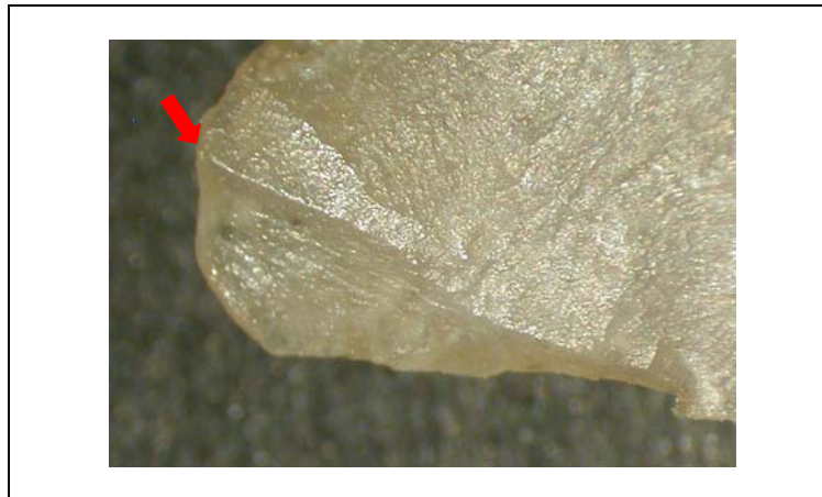
Figure 219 : Fracturation en flexion et torsion avec point d'initialisation et rides d'arrachement.
