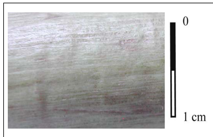
Figure 60 : Abrasion fine sur bois frais de forte densité (Frêne, Fraxinus excelsior ) montrant un aspect lustré (résultats expérimentaux Exp.02 E.A.F.; cliché Dias-Meirinho).
