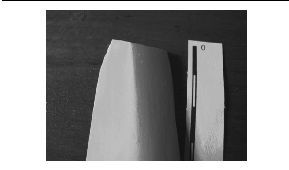
Figure 182 : Polissage incliné avec les prémices d'une arête longitudinale (temps de réalisation : 2h10 ; résultats expérimentaux Exp01 P.I, juillet 2008).
