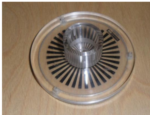
Figure 3-13 Porte-échantillon comprenant la mire et dans lequel la cornée à étudier est placée. Cet ensemble est à positionner sous l'objectif du microscope. Ce porte échantillon a été élaboré par Tal Marciano dans le cadre du projet ASTRE et de son travail de doctorat.
