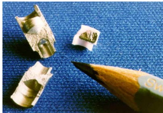
Figure 3 : Creuset d'alumine (à droite) et creuset de tungstène (à gauche), après ATD. On observe une forte réactivité entre l'échantillon ( ZrAu ) et le creuset d'alumine, tandis qu'un échantillon de même composition ( ZrAu ) fondu en creuset de tungstène se démoule sans réaction entre l'échantillon et le creuset. La température de fusion congruente de ZrAu est 1575^\circ\text{C} .
