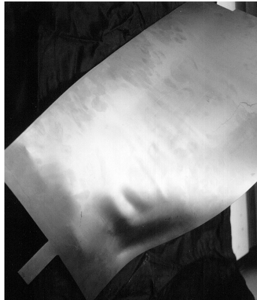
FIG. 3.2: Pièces primaires ayant subi un flambage lors du formage.
