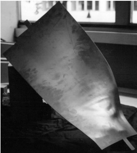
FIG. 3.2: Pièces primaires ayant subi un flambage lors du formage.
