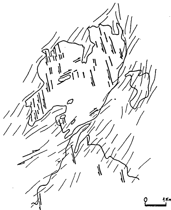
Fig. 10 : Cinématique de la déformation dans les zones de cisaillement ductiles des plutons du Baméga-Tabouchent, (d'après SAQUAQUE, 1985),
