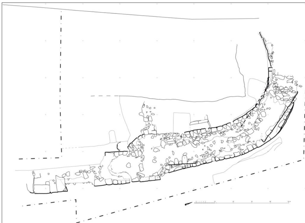
Fig. n° 15. Plan du mur oriental de l'abside et du début du mur gouttereau de la nef (relevé et D.A.O. : M. Varano).
