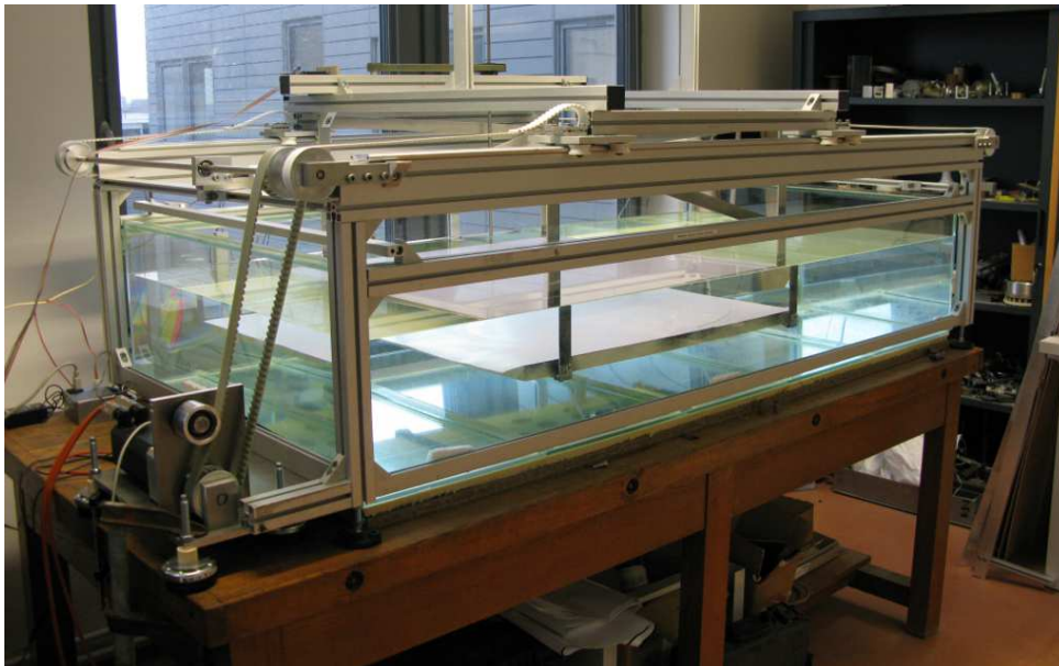
FIG. 3.5: Montage expérimental 2. Nouvelle version du dispositif expérimental permettant l'étude de champs de dunes. Ce montage a été développé par Mathieu Receveur au sein du laboratoire MSC.
