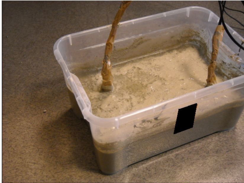
FIGURE 2.21 – Configuration expérimentale : deux microphones enfouis dans un bloc de ciment et espacés de 25 cm.
