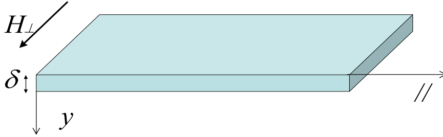
Figure B-1 : La Géométrie considérée pour calculer la dépendance fréquentielle de la perméabilité perpendiculaire.
