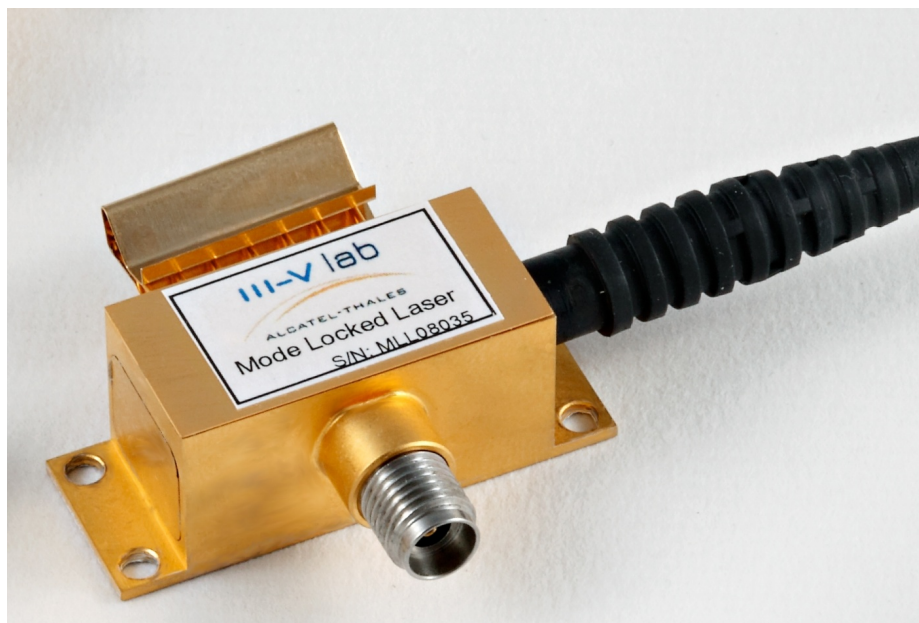
FIGURE 4.12 – Photo du module du laser Fabry-Perot.
