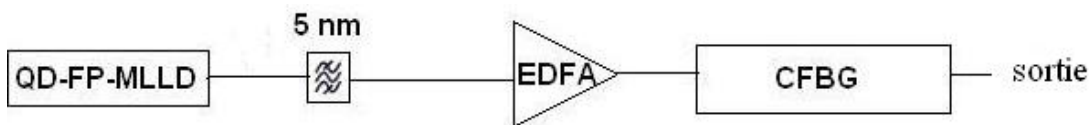
FIGURE 5.1 – Configuration expérimentale de la génération d’horloge. Après filtrage et amplification, le signal du laser à bâtonnets quantiques est injecté dans le réseau de Bragg.
