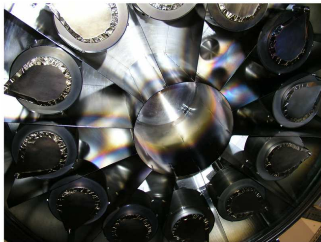
FIGURE 2.8 – Photographie de l'intérieur de la chambre de dépôt avec ses 12 cibles.
