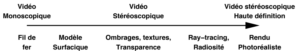
FIGURE 6: Degré de fidélité du monde en fonction de la technologie d’affichage et du rendu.
