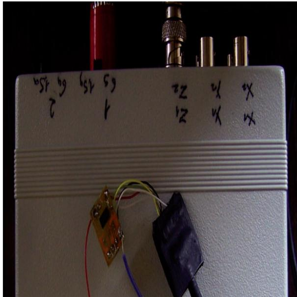
FIGURE 5.29 – Présentation de l'accéléromètre MMA7361L utilisé
