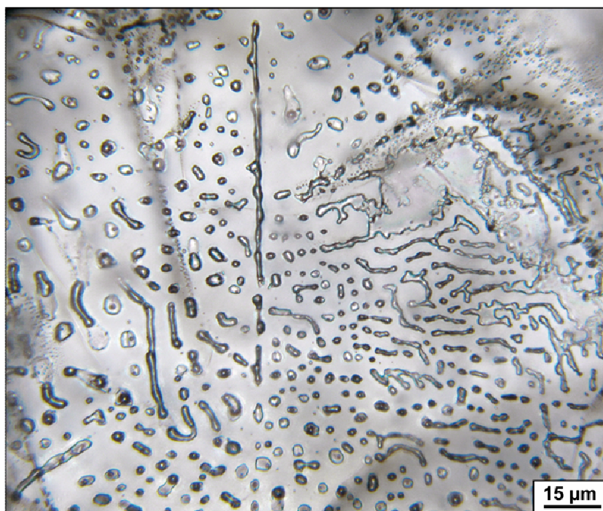
Figure A8. Photographie en lumière transmise d'une fracture à un stade avancé de cicatrisation dans une olivine mantellique, comme en témoigne la présence de nombreuses inclusions silicatées (transparentes) et fluides (noires) de forme cylindrique et sphérique. Noter l'ovulation inachevée de l'inclusion cylindrique verticale au centre de la photographie. Origine du xénolithe : îles Kerguelen, Océan Indien.
