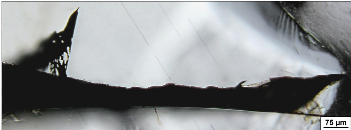
Figure A26. Photographie en lumière transmise de deux fractures infiltrées par un liquide métallo-sulfuré dans une olivine de la pallasite Brenham. La cicatrisation des plans de fracture est quasiment inexistante.
