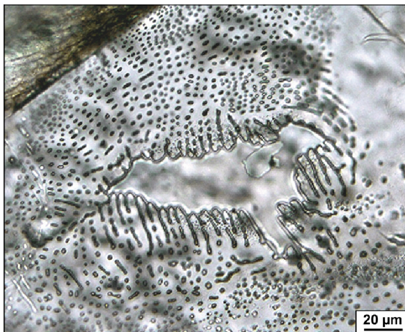
Figure A2. Photographie en lumière transmise illustrant la cicatrisation inachevée d'un plan de fracture par un liquide silicaté dans une olivine mantellique. Origine du xénolithe : îles Kerguelen, Océan Indien.
