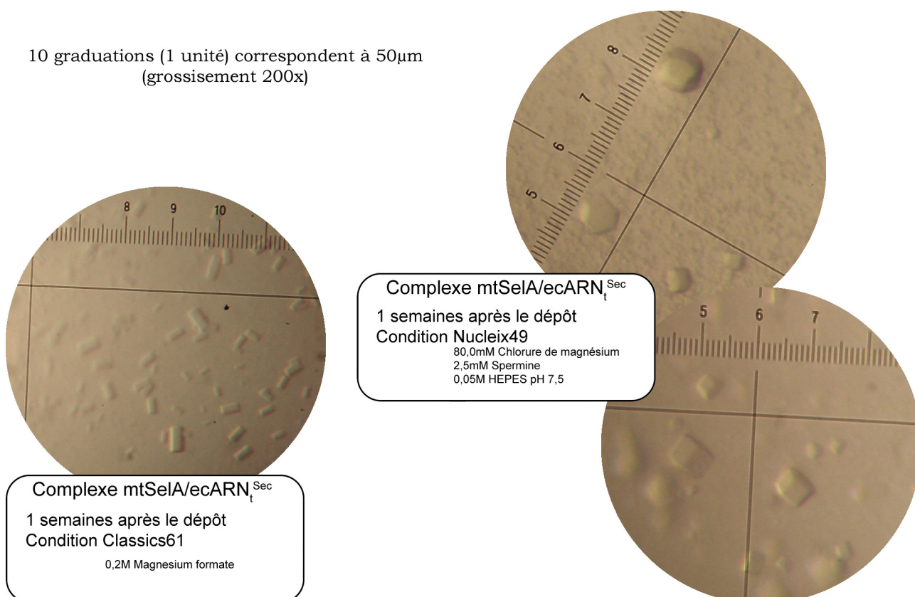
Figure 3.20 – Morceaux choisis de la Cristallogenèse n°7, points de départ d'une stratégie d'optimisation de conditions de cristallisation.
