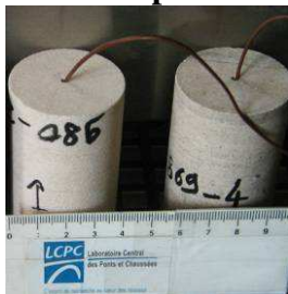
Figure 2-32 Mesure de la température de surfusion et de la température de gel à l'aide de thermocouples placés dans les échantillons du calcaire de Chamesson (à droite) et de la Pierre de Lens (à gauche).
