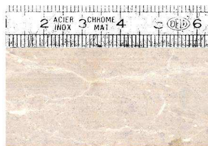
Figure 5-16 Fissures présentes en surface des échantillons du calcaire au faciès très altéré, elles sont remplies de calcite.
