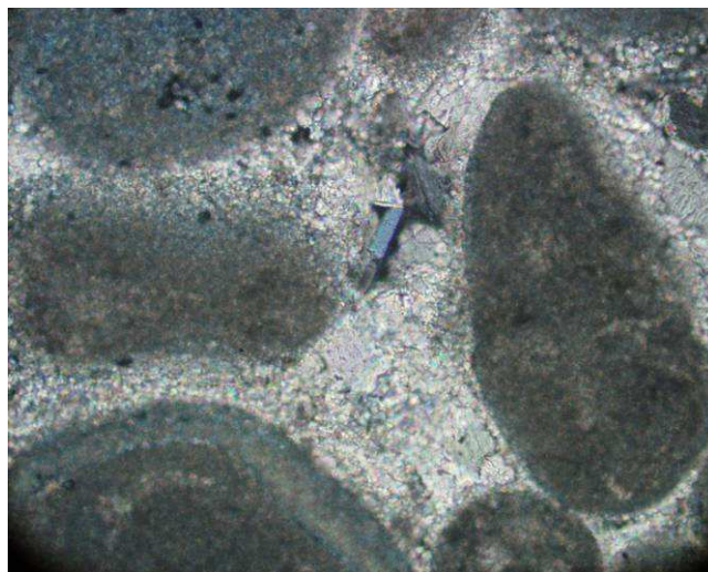
Figure 2-15 Le ciment est composé de sparite, microscope optique, lumière polarisée et analysée (LPA, x50). La résine bleue indique les vides autour des oolithes.
