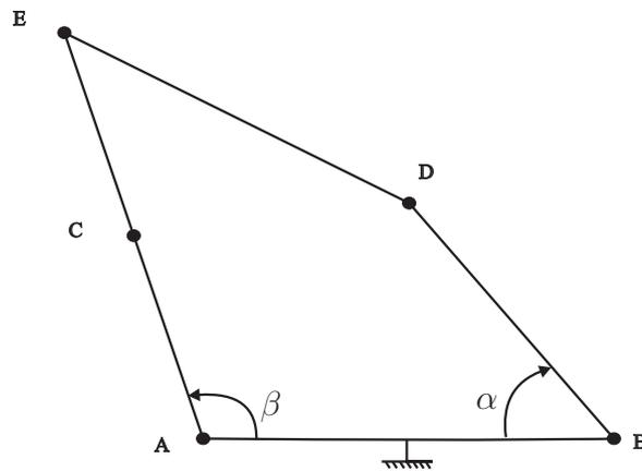
**Figure 2.4:** – Articulation à 5-barres en position singulière de type sériel.
