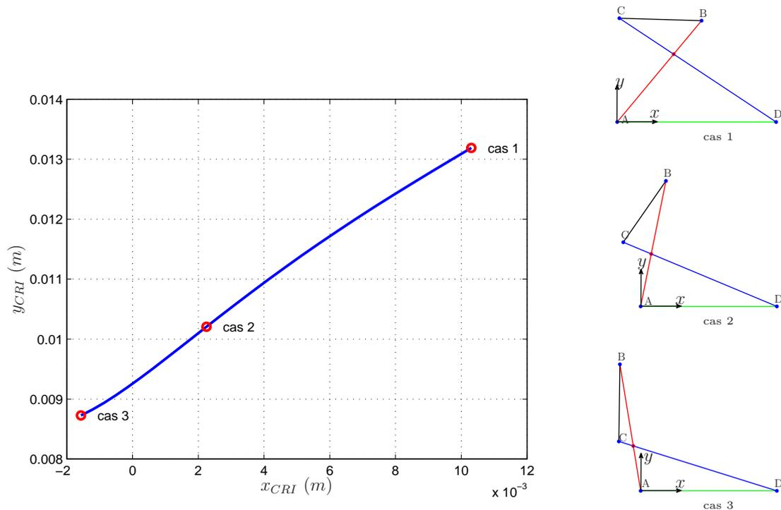
**Figure 2.13:** – Tracé de l'évolution du CRI pour différentes positions de l'articulation du genou.
