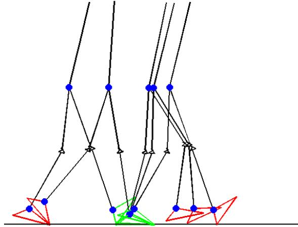
**Figure 5.42:** – Marche de type 3 pour une vitesse de marche de  $2.5 \text{ km/h}$  avec des genoux à 4-barres
