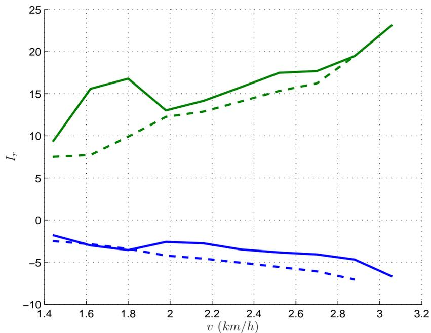
**Figure 5.18:** – Amplitude des impacts pour différentes vitesses de marche. En bleu : composante tangentielle de la réaction du sol, en vert : composante normale de la réaction du sol. En continu : robot à genoux pivots, en pointillé : robot à genoux 4-barres.
