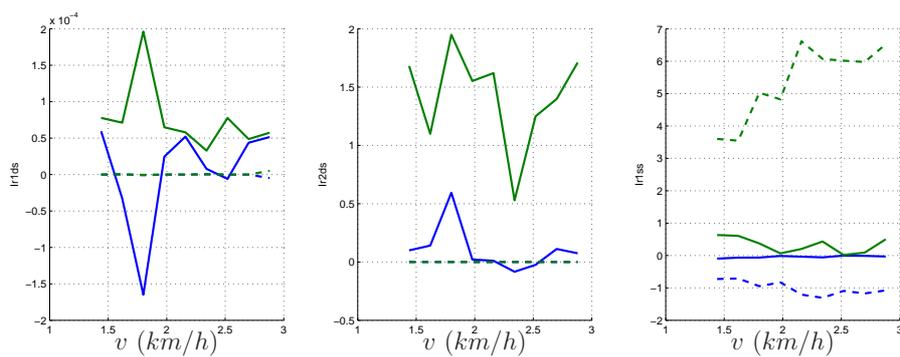
**Figure 5.39:** – Amplitude des impacts pour différentes vitesses de marche de type 2. Trait continu : robot à genoux pivots. Trait pointillé : robot à genoux 4-barres. En bleu : composante normale, en vert : composante tangentielle. A gauche et au centre : impacts sur les pieds 1 et 2 en fin de phase de simple appui. A droite : impact en fin de phase de double appui.
