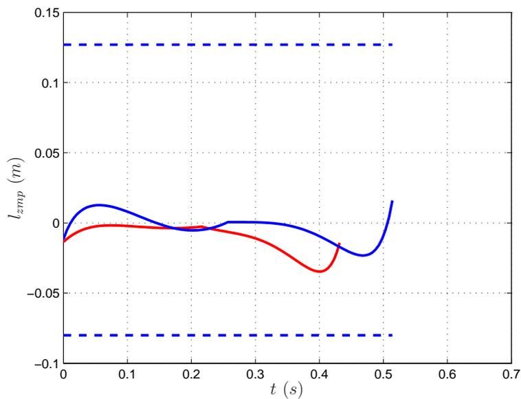
**Figure 5.55:** – Évolution du ZMP pour une vitesse de  $2.2 \text{ km/h}$ , pour un robot utilisant des genoux à 4-barres ressort. En bleu : robot avec ressorts en torsion, en rouge : robot avec ressorts en extension, en pointillé : limite de la semelle.
