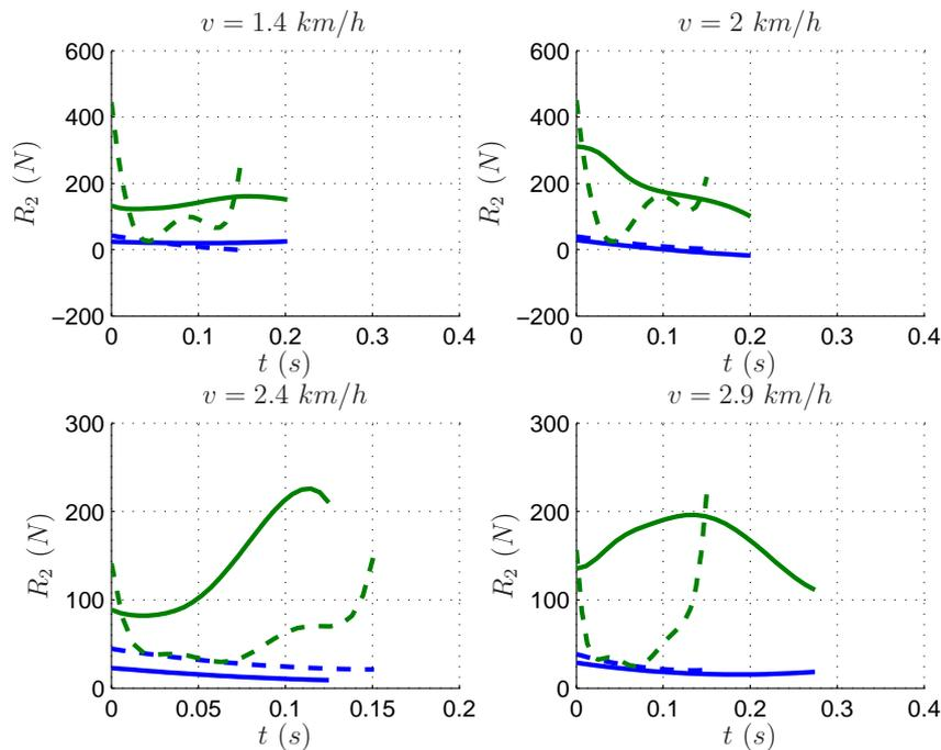
**Figure 5.41:** – Composante tangentielle (en bleu) et normale (en vert) de la réaction du sol sur le pied 2 pour plusieurs vitesses. En continu : robot à genoux pivots, en pointillé : robot à genoux 4-barres.
