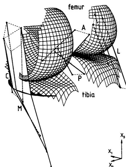
**Figure 1.9:** – Modèle mathématique des surfaces articulaires d’un genou humain en 3D [Blankevoort and Huijkes, 1996]
