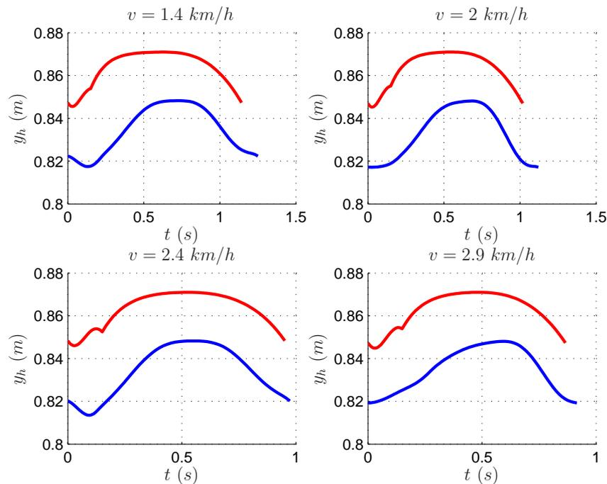
**Figure 5.37:** – Évolution de la position verticale de la hanche pour différentes vitesses de marche.
