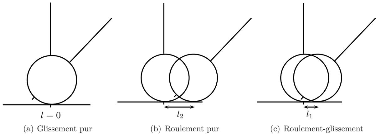
**Figure 1.5:** – Illustration du mouvement de roulement-glisement [Klein and Sommerfeld, 2008].
