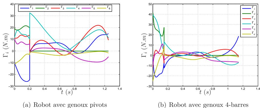
Figure 5.30: – Évolution des couples articulaires pour une vitesse de marche de 1.4  $km/h$
