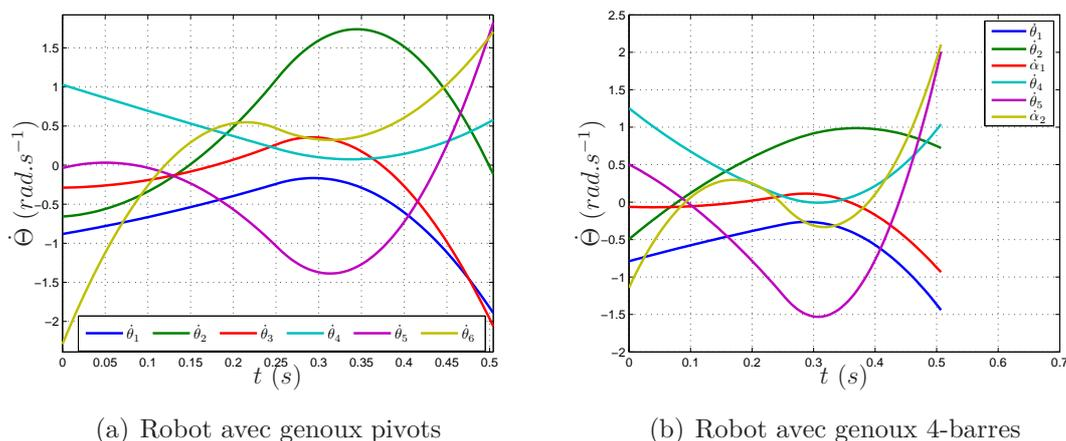
**Figure 5.9:** – Évolution des vitesses articulaires actionnées pour une vitesse de marche de  $1.4 \text{ km/h}$
