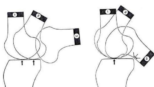
**Figure 1.7:** – Illustration des comportements extrêmes en cas de roulement pur ou glissement pur [Klein and Sommerfeld, 2008].
