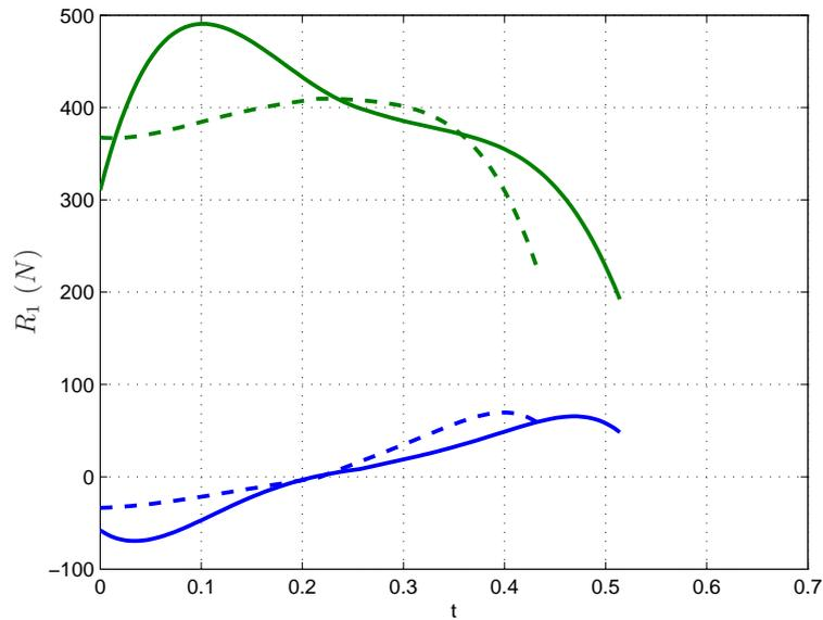
**Figure 5.54:** – Évolution des composantes normale et tangentielle de la force de réaction du sol pour une vitesse de  $2.2 \text{ km/h}$ . En bleu : Force tangentielle. En vert : Force Normale. Trait continu : robot avec ressorts en torsion. Trait pointillé : robot avec ressorts en extension.
