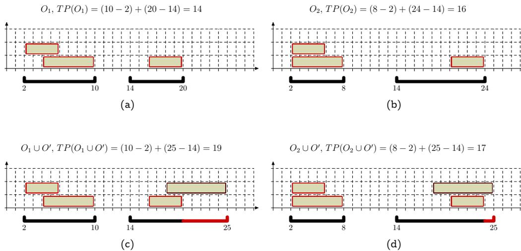
**Fig. 5.4.2** Le critère temps de présence  $TP$  est croissant si on ajoute des tâches (ie  $TP(O) \leq TP(O \cup O')$ ) mais il ne conserve pas l'ordre entre  $O_1$  et  $O_2$  :  $TP(O_1) = 14 < TP(O_2) = 16$ . Cependant, après extension avec l'ordonnancement  $O'$  composé d'une seule tâche, on obtient que  $TP(O_1 \cup O') = 19 > TP(O_2 \cup O') = 17$ . Remarquons bien que ni  $O_1$  ni  $O_2$  ne domine localement l'autre.
