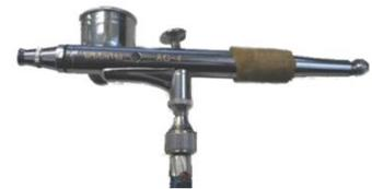
Figure 64 : Pistolet à peinture de type artiste utilisé pour nos dépôts
