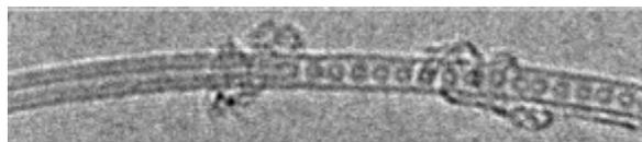
**Figure 7 : Formation de la paroi interne d'un DWNT par coalescence d'endofullerènes (visible dans le SWNT sur la droite de l'image) <sup>66</sup>.**
