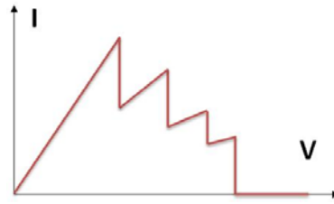
Figure 43 : Caractéristique I (V) typique d'un système de 4 NTC métallique parallèles soumis à une rampe de tension de grande amplitude.
