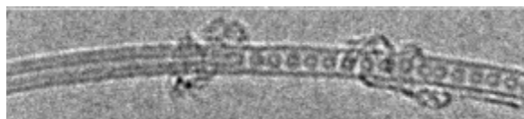
Figure 7 : Formation de la paroi interne d'un DWNT par coalescence d'endofullerènes (visible dans le SWNT sur la droite de l'image) 66 .
