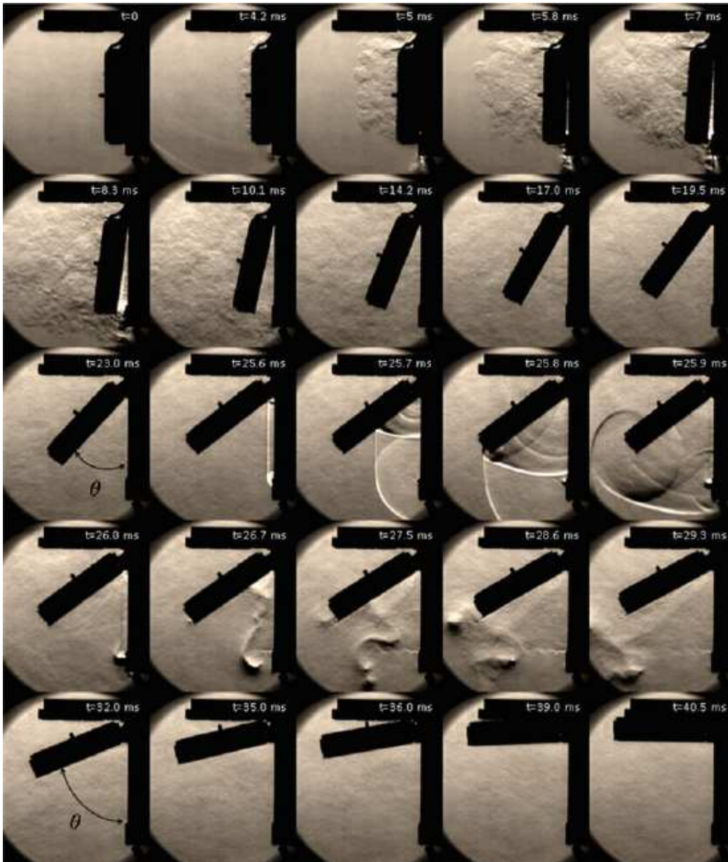
FIG. 6.10 – Photographies de strioscopie obtenues expérimentalement à différents instants (reprises de [12])
