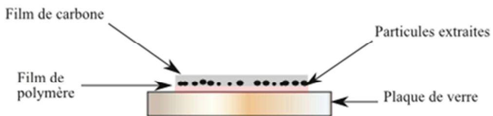
Figure B.1 – Schéma de la réplique après le dépôt du film de carbone.
