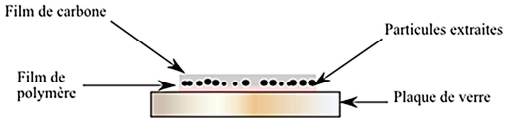
Figure 2.21 – Schéma de la réplique après le dépôt du film de carbone.
