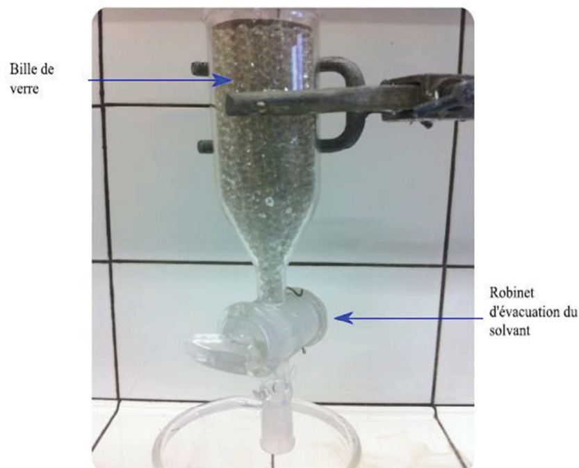
Figure B.3 – Photographie du montage expérimental pour la dissolution du polymère de la réplique.
