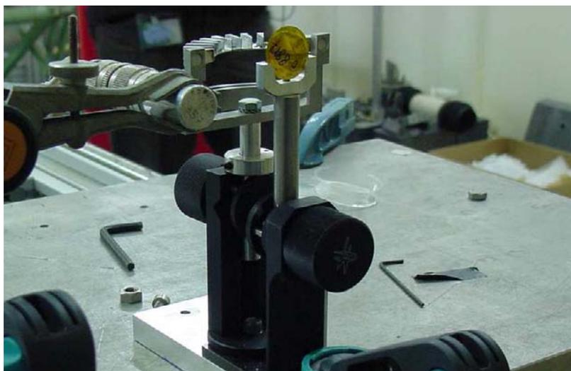
FIG. 6.2 – Photo de l'ensemble de cibles utilisé lors de la mesure sur l'installation ELSA. En arrière des cibles Cu, RbCl et Au se trouve le support d'échantillons de cuivre qui permet de vérifier que le faisceau est resté spatialement homogène durant les irradiations. Pour s'assurer de cela il faut que les activations sur les différents échantillons de cuivre soient similaires. Ce système de croix est identique à celui utilisé sur les expériences RX2 (Cf. Chapitre 5).
