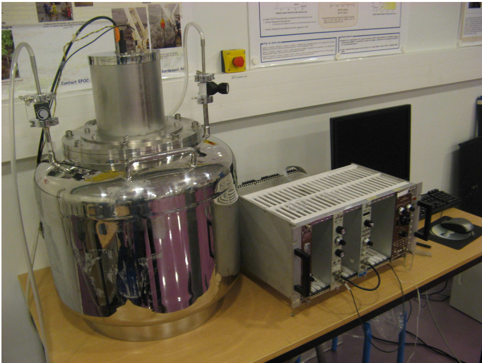
Détecteur de radon par collection électrostatique (KAMIOKANDE, Japon).
