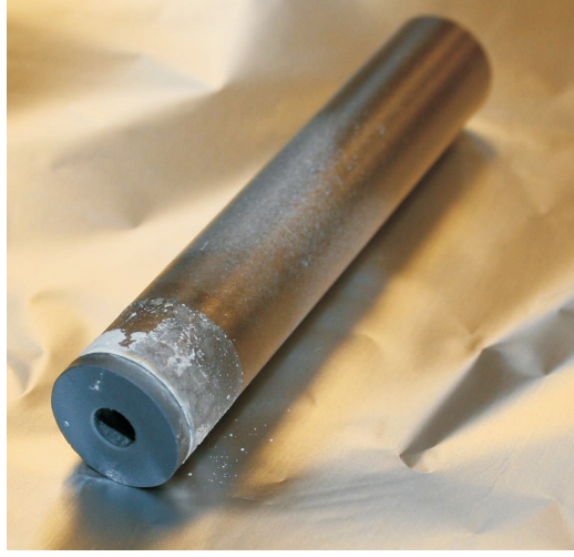
FIGURE 1.4 – Photographie de l'insert en zircone. Après 15 mois d'utilisation, le barreau de chrome à l'intérieur est entièrement consommé. La couleur gris métallisé provient du dépôt du chrome sur l'insert qui, lui, est plutôt de couleur beige-orange. La poudre blanchâtre provient de la colle haute température servant à maintenir le bouchon.
