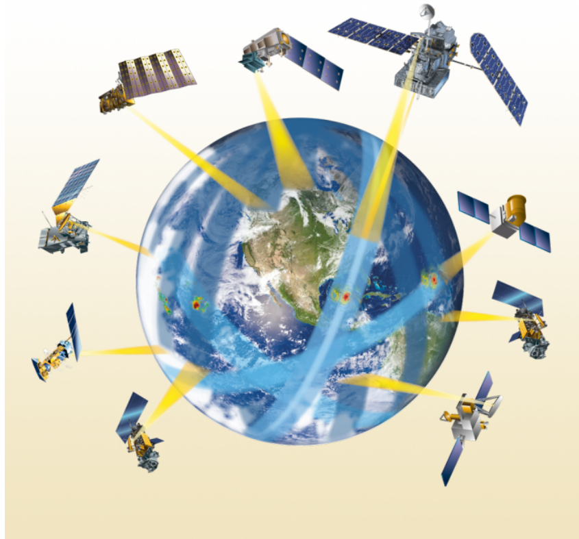
Figure 4.1 – Vue d'artiste de la future constellation de satellites, pourvus de radiomètres à micro-ondes passives, issue de la coopération internationale du programme GPM (Source : http://pmm.nasa.gov/ )
