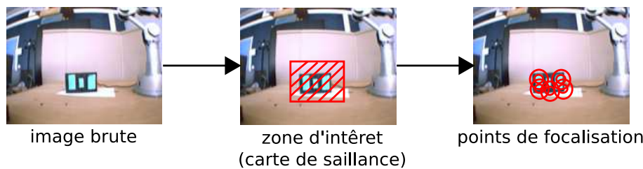
Fig. 7-8 – Chaîne de traitement visuelle. Le robot focalise sur une zone d'intérêt dans l'environnement (zone saillante: couleurs et textures). Une fois cette zone sélectionnée, des points de focalisations sont extraits sur cette zone grâce aux Différences de Gaussiennes (DOG).
