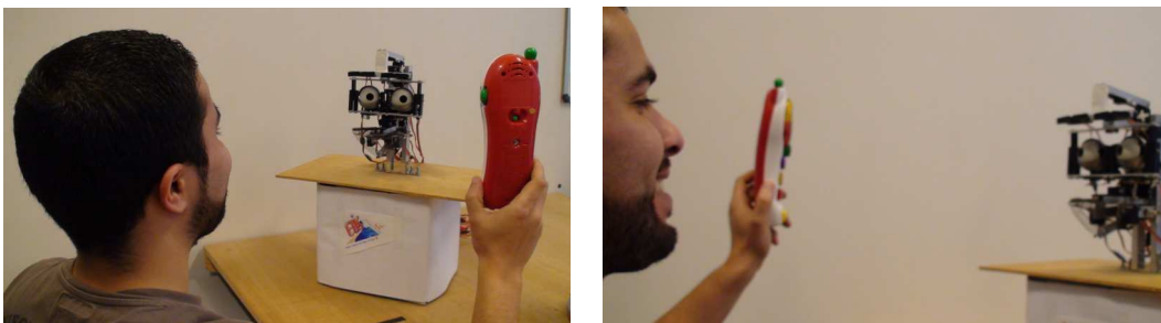
Fig. 9.2 – Set-up expérimental d’une expérience mêlant des capacités d’attention conjointe et de référencement social. La tête de robot expressive est capable d’apprendre à reconnaître des expressions faciales de l’expérimentateur et peut également orienter son regard en fonction du regard de l’expérimentateur.
