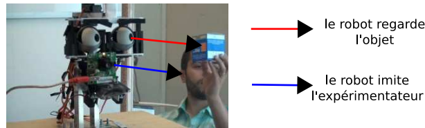
Fig. 9-5 – Set-up expérimental (phase de test): l’humain interagit avec le robot dans un contexte d’attention conjointe. L’humain dirige son regard vers un objet dans le but d’attirer le regard du robot sur cet objet.
