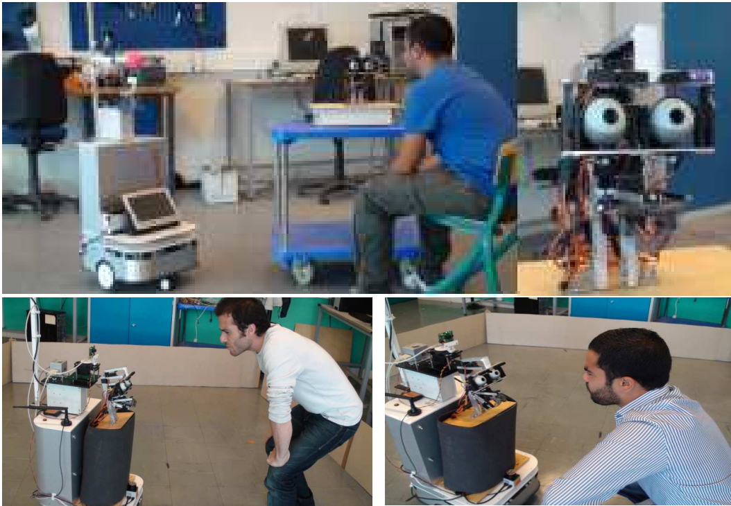
Fig. 8-1 – Set-up expérimental: la tête de robot apprend à reconnaître les expressions faciales d'un partenaire interagissant avec elle, alors que la base mobile permet au robot d'explorer son environnement, d'apprendre des lieux et des conditionnements lieux-actions. Les primitives visuelles utilisées pour la localisation du robot sont les mêmes que celles utilisées pour la reconnaissance des expressions faciales. La taille de la pièce est de 7m x 7m.
