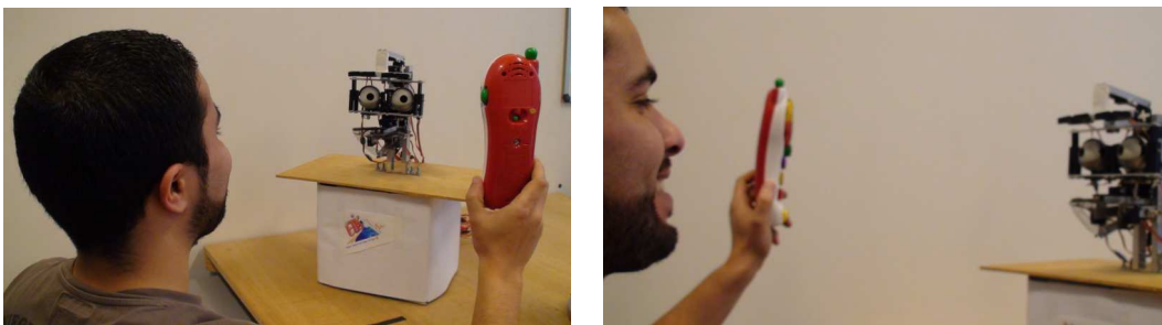
Fig. 9.2 – Set-up expérimental d’une expérience mêlant des capacités d’attention conjointe et de référencement social. La tête de robot expressive est capable d’apprendre à reconnaître des expressions faciales de l’expérimentateur et peut également orienter son regard en fonction du regard de l’expérimentateur.
