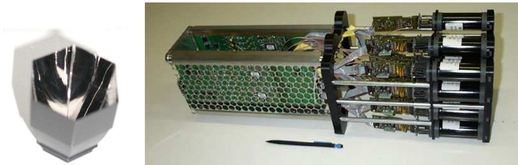
FIG. 2.10 – Gauche : Photographie d'un cône de Winston. Droite : Photographie d'un tiroir contenant 16 PMs et l'électronique associée.
