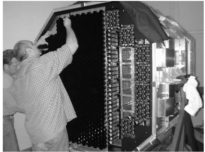
FIG. 2.9 – Gauche : Vue éclatée d'une des caméras de HESS. Droite : Photographie d'une des caméras de HESS où on distingue l'emplacement de plusieurs tiroirs manquants et une partie des cônes de Winston disposés devant les faces des PM.
