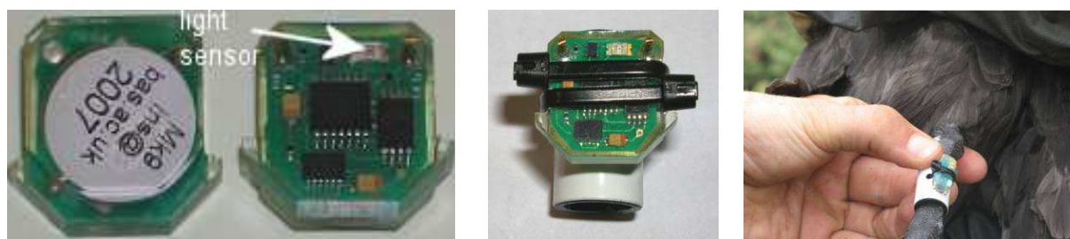
Figure I.13 : Photographies des GLS (British Antarctic Survey) posés sur les pétrels à menton blanc nichant à Kerguelen (article 2) et montage sur une bague plastique.
