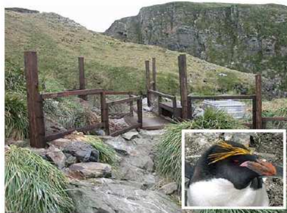
Figure 26. Illustration du portique de détection de gorfous transpondés, mis en place en Géorgie du Sud (d'après Green et al. 2006)
