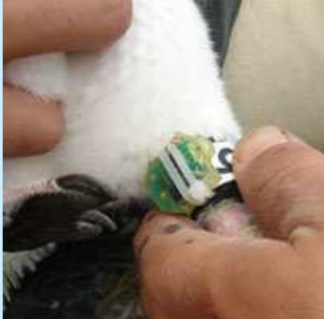
Montage d'un enregistreur de lumière sur une bague ajustée à une patte de Gorou (photos : British Antarctic Survey, JB Thiebot, Y Charbonnier)
