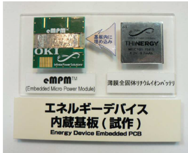
Figure IV-3-1 : Intégration d'une batterie fine dans le PCB par la société asiatique OKI (juin 2010)
