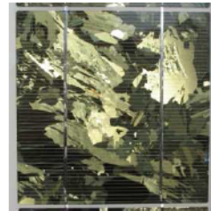
Figure I-3-4 : Cellule en silicium polycristallin [93]
