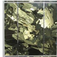
**Figure I-3-4 : Cellule en silicium polycristalin [93]**
