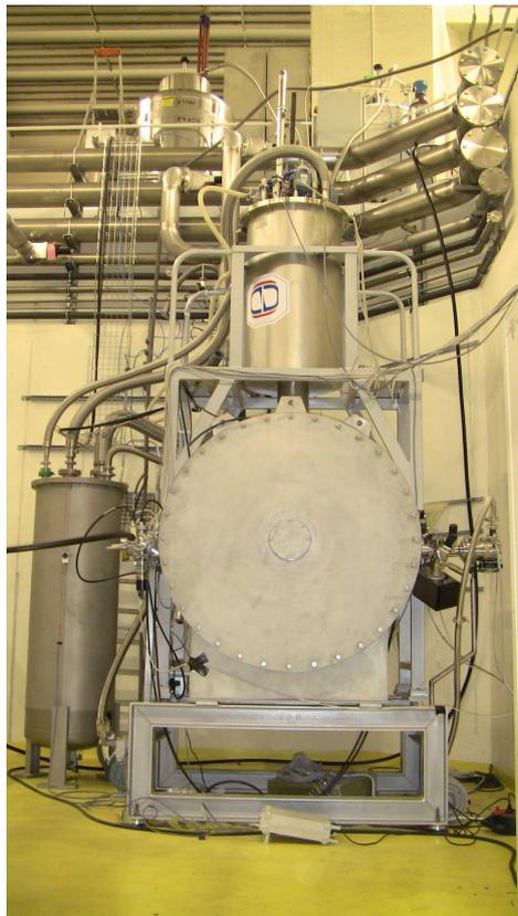
Le Cryomodule installé dans la fosse expérimentale à l'IPNO, lors de son premier test.
