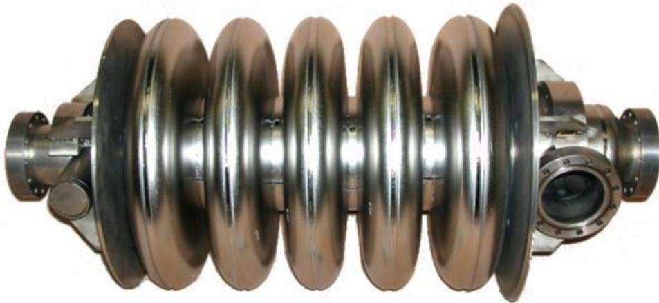
Psyché, la cavité multi-cellules (704,4 MHz ;  $\beta_g = 0,47$ ) destinée au banc de test pour l'étude de la « tolérance aux fautes » d'un module accélérateur supraconducteur.
