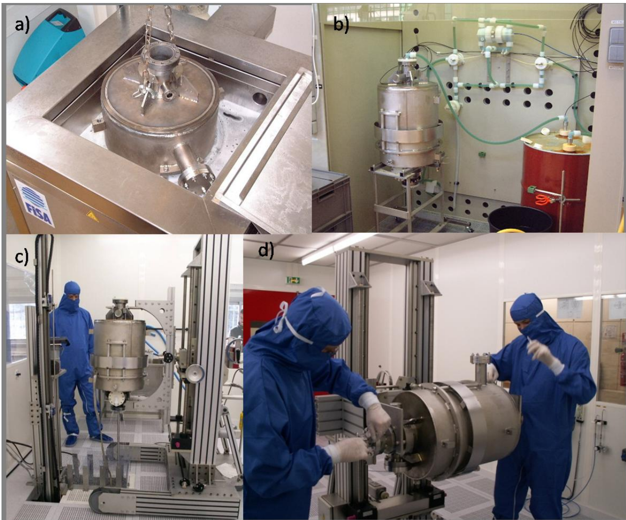
FIGURE 4.19 – a) Dégraissage de la cavité dans le bac à ultrasons. b) Attaque chimique en circuit fermé, sous hotte. L'oxyde de niobium donne une coloration verte à l'acide. c) Procédure de HPR en salle blanche. d) Montage des brides et fermeture de la cavité en salle blanche.
