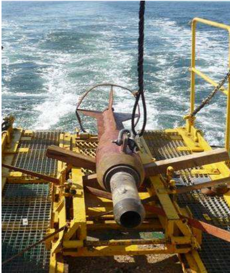
Figure 9 : Le carottier à roche Cnexoville utilisé au cours de la mission Carobseine (N/O Ifremer/Genavir Thalia, avril 2009).
