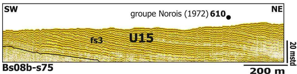
Figure 1.29 : Profil sismique Bs08b-s75 d'orientation SW-NE localisé au Nord de la baie de Seine présente l'unité sismique U15. Le point de prélèvement (station 610, groupe Norois, 1972) permet d'attribuer cette unité à la craie cénomaniennne.
