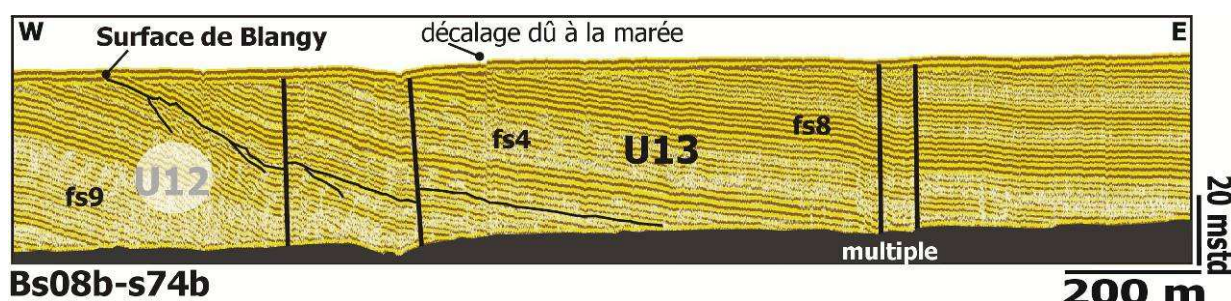
Figure 1.27 : Profil sismique Bs08b-s74 d'orientation W-E localisé dans la partie orientale de la baie de Seine. Il présente le faciès de l'unité sismique U13 attribuée à la série marneuse de l'Oxfordien supérieur – Kimméridgien.
