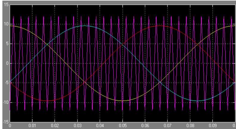
Figure 3.59 : Signaux de modulation sinus-triangle
