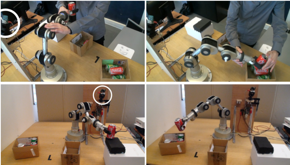
FIGURE 7.3 – Exemple d’une tâche de tri d’objets grâce à un guidage manuel du bras par l’humain. Suite à une démonstration par un humain pendant laquelle le robot est forcé à déposer des canettes rouges dans la boîte 1, le robot apprend une “carte cognitive” (séquence) qui lui permet de reproduire la tâche. La caméra est orientée vers le point de collecte pour reconnaître la couleur de la canette.
