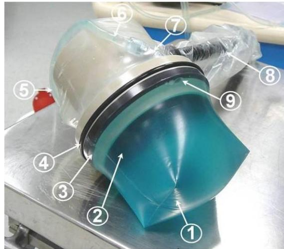
**Figure 23** : Prototype HIFU torique préparée pour un traitement, (1) Ballonnet de refroidissement, (2) transducteur torique de thérapie, (3) bague de refroidissement, (4) joint torique d'étanchéité, (5) entrée du circuit de refroidissement, (6) sortie du circuit de refroidissement, (7) luaine, (8) câble de sonde recouvert par une enveloppe stérile, (9) trou de circulation d'eau dans la bague de refroidissement
