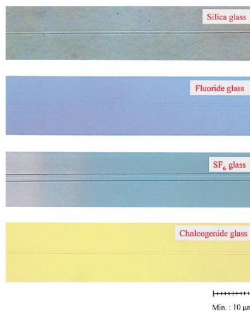
Figure I-17 : Observation par microscopie optique en transmission de guides d'ondes inscrits dans différents verres par un laser émettant à 800 nm de durée d'impulsion 120 fs à 200 kHz au travers d'un objectif de NA = 0,1 [Hirao 1998]
