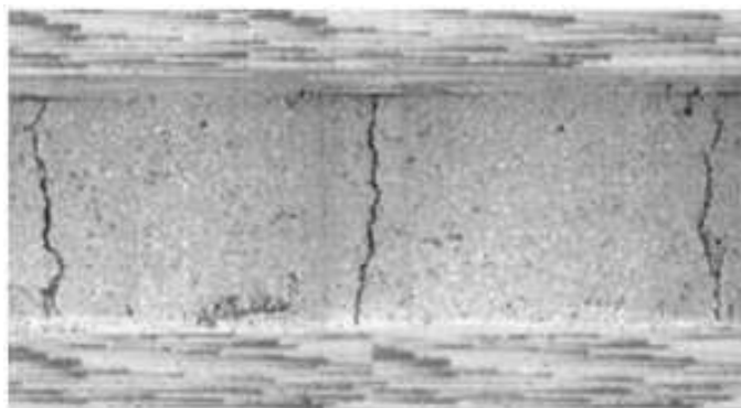
FIGURE 1.6 : Fissures transverses d'un pli avec création de délaminage local en pointe de fissure [Blázquez et al. , 2009]
