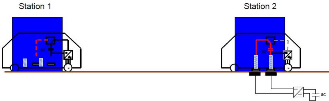
**Figure 1.9 : Principe d'alimentation par biberonnage**
