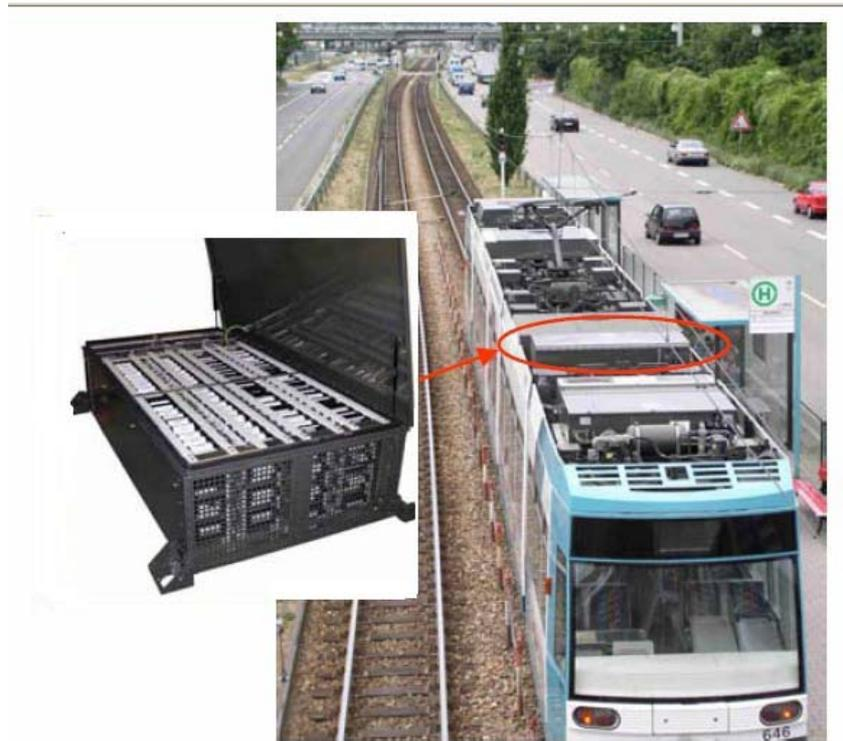
**Figure 1.8 : Tram Bombardier avec supercondensateurs.**
