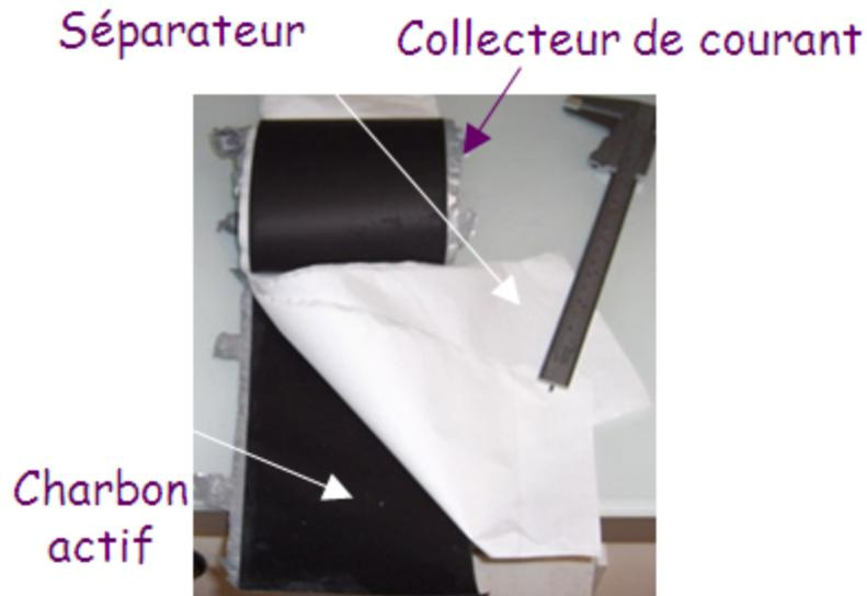
Figure 1.2 : Structure du supercondensateur [6].
