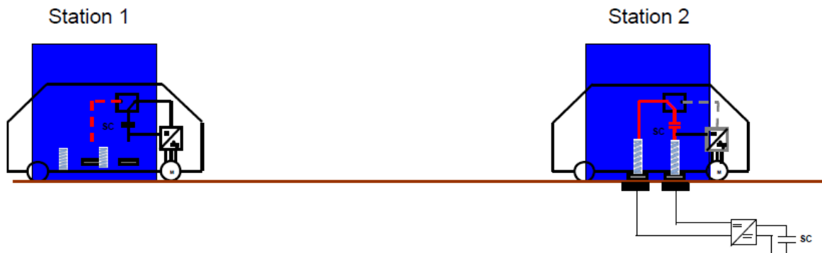
Figure 1.9 : Principe d'alimentation par biberonnage
