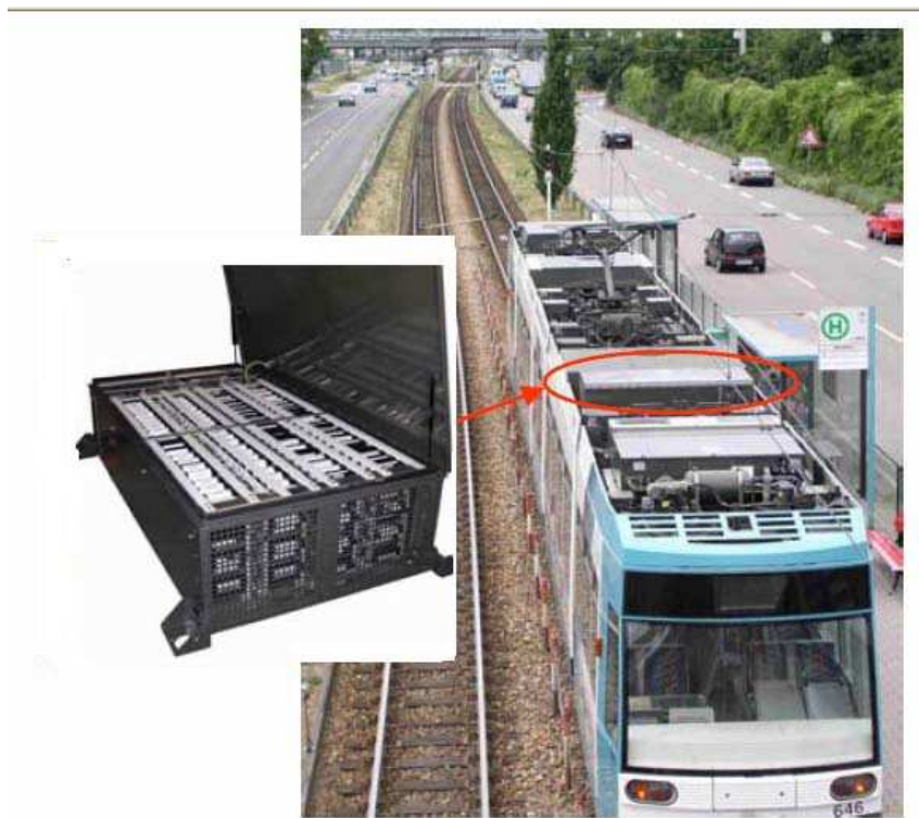
Figure 1.8 : Tram Bombardier avec supercondensateurs.
