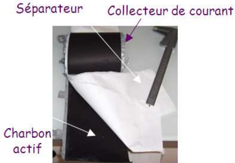
Figure 1.2 : Structure du supercondensateur [6].
