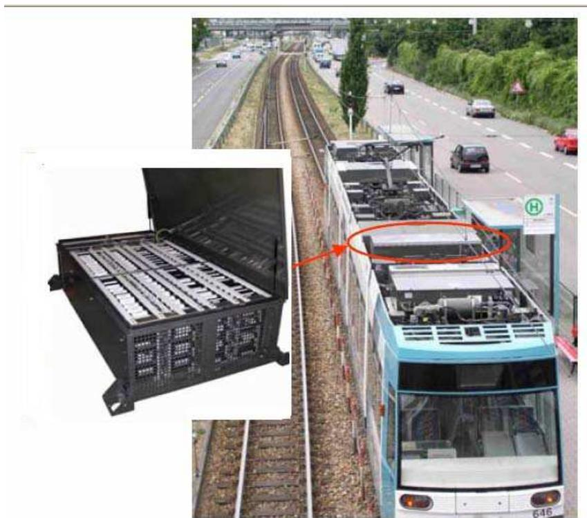
**Figure 1.8 : Tram Bombardier avec supercondensateurs.**
