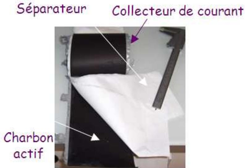
**Figure 1.2 : Structure du supercondensateur [6].**
