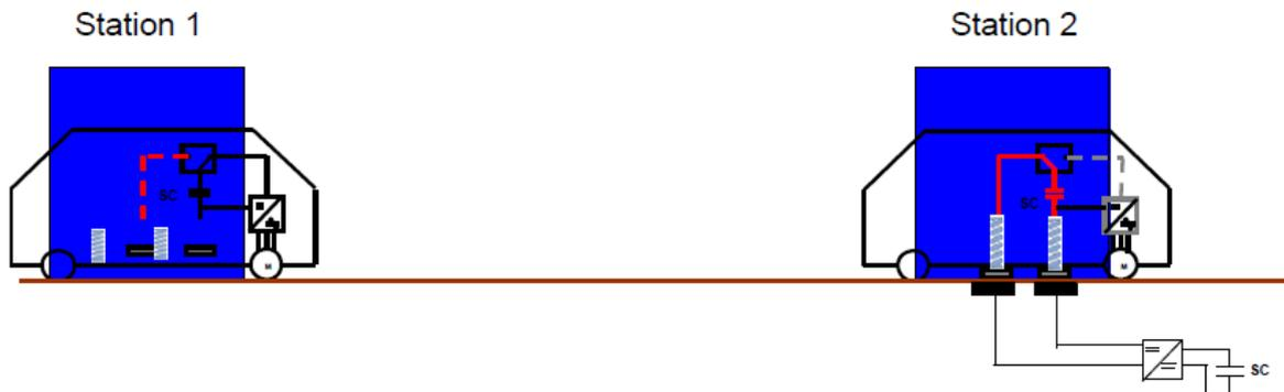
Figure 1.9 : Principe d'alimentation par biberonnage
