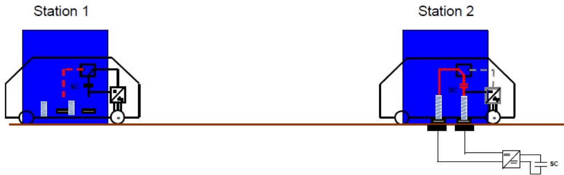
Figure 1.9 : Principe d'alimentation par biberonnage
