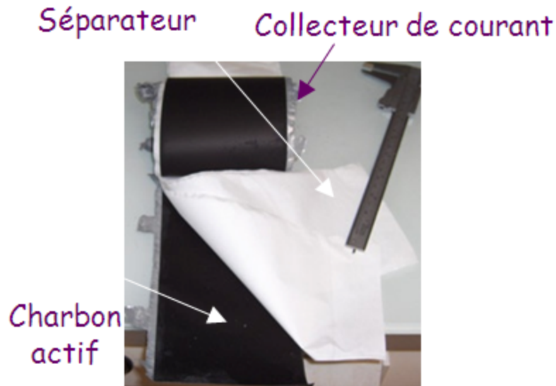
Figure 1.2 : Structure du supercondensateur [6].
