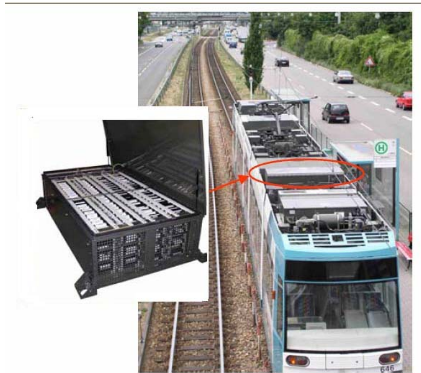
Figure 1.8 : Tram Bombardier avec supercondensateurs.
